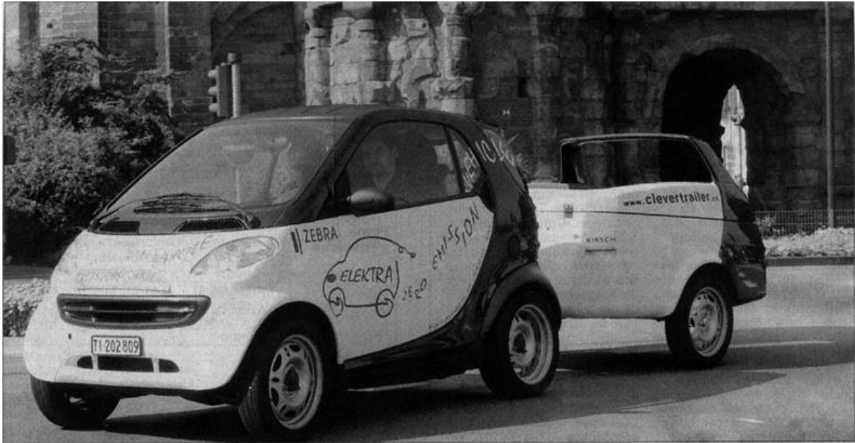
Ideales Stadtauto: Das Hybridauto der Fachhochschule Trier hat eine Reichweite von 100 Kilometern. Bei Bedarf kann ein Verbrennungsmotor, der im zusätzlichen Anhänger untergebracht ist, zugeschaltet werden. Foto: Hans Krämer
